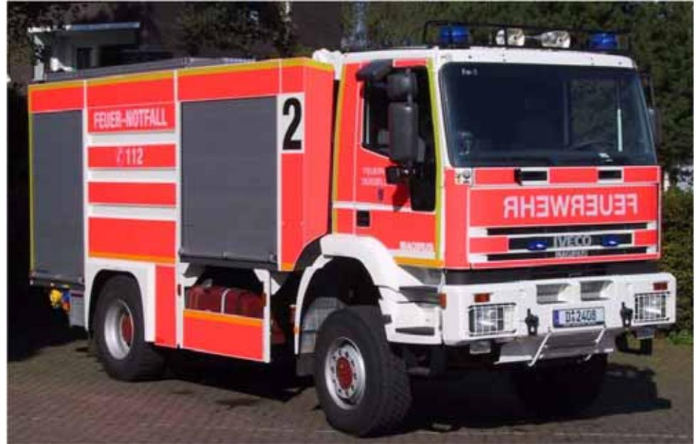
sperren (Längs- und Hinterachsdifferenzial) über eine gute Geländegängigkeit, wobei das Gewicht von 19 Tonnen nicht zu vernachlässigen ist. Probleme mit der hinteren Achslast wurden inzwischen durch die Firma IVECO behoben (Tankumbau).
