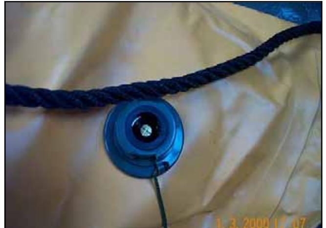
regelmäßig durch das Personal des Feuerlöschboots geprüft und gewartet. Darüber hinaus kann auf der Wache die Auslöseautomatik kontrolliert werden. Dies erfolgt einfach durch eine Sichtkontrolle der drei grünen Punkten. Diese geben Aufschluss darüber, ob die Treibgaspatrone richtig eingeschraubt, die Papiertablette intakt ist und ob sich die Handauslösung in
