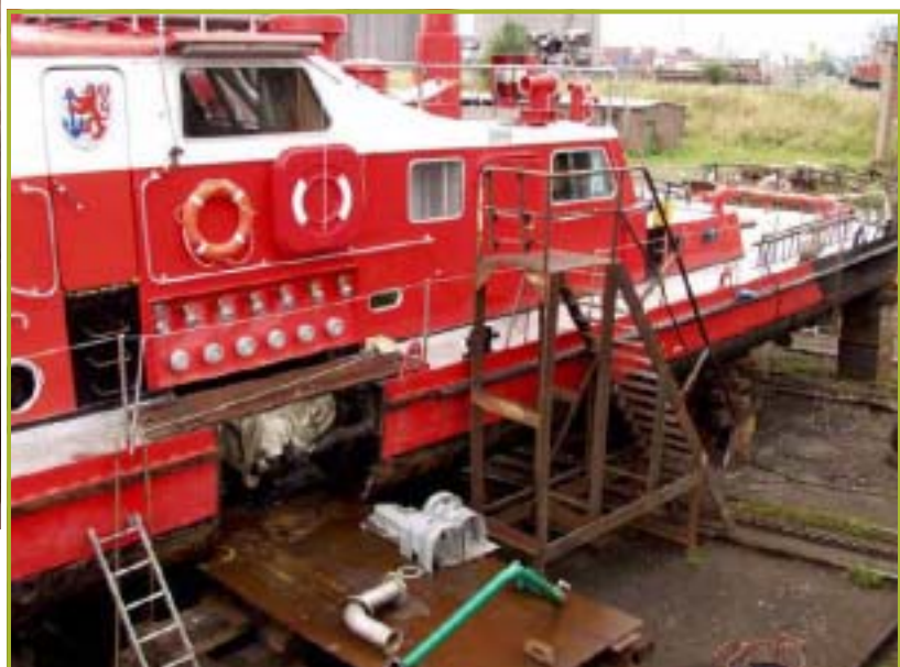
Der Rumpf des Löschbootes ist aufgeschnitten, im Maschinenraum werden die Motoren für den Ausbau vorbereitet.
