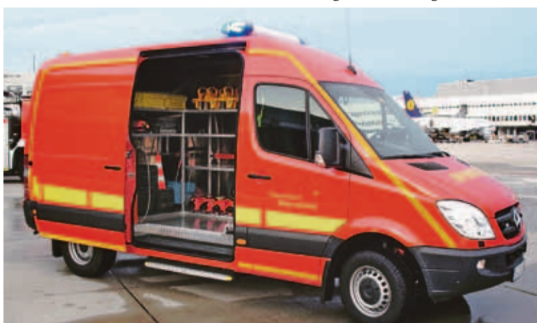
Sollten Betriebsstoffe auslaufen, ist die Flughafenfeuerwehr mit dem neuen Öl-Gerätewagen schnell vor Ort, um die Ausbreitung zu verhindern.
