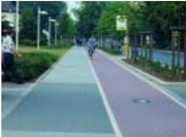
Farbe empfohlen. Der Einbau einer Trennkante ist dabei wegen der Sturzgefahr für Radfahrer nicht sinnvoll. In Abschnitten mit starker Fußgängerquerung (z.B. an Bushaltestellen) ist eine Radwegführung hinter den Wartebereichen anzustreben.
