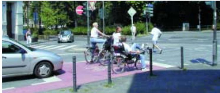
Wartezeiten vermeidet und der idealtypischen Fahrlinie der Radfahrer entspricht. Sie lässt sich in der Regel ohne weitere lichtsignaltechnische Maßnahmen praktizieren, wenn ausreichende Zeitlücken zum Linkseinfädeln zur Verfügung stehen, das vorhandene Geschwindigkeitsniveau im Kfz-Verkehr 50 km/h nicht überschreitet und beim Einordnen höchstens ein
